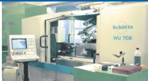
Schütte, 6-axlig slipmaskin. Plana brotschar: max bearbetningslängd 750 mm. Runda roterande verktyg: spännområde Ø 6 - 32 mm.
