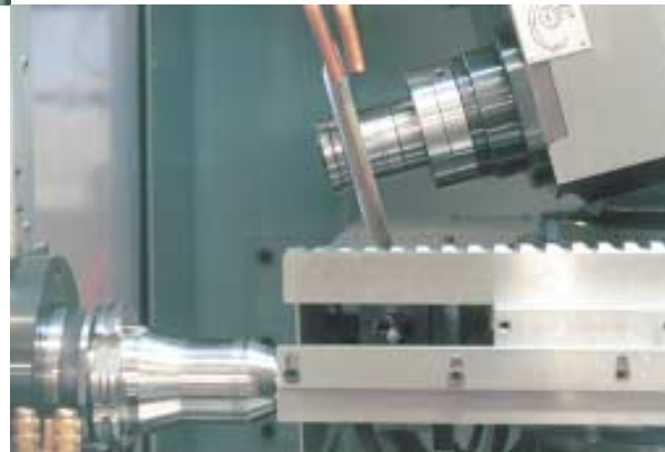
Schütte, 6-axlig slipmaskin. Plana brotschar: max bearbetningslängd 750 mm. Runda roterande verktyg: spännområde Ø 6 - 32 mm.
